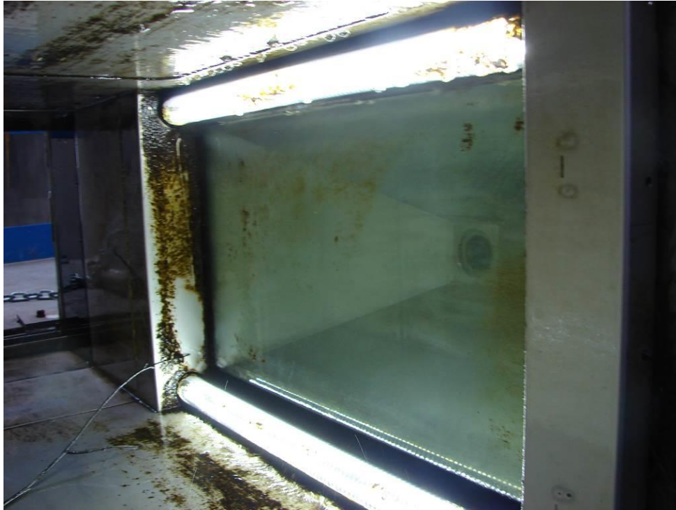
Fot.11- Wnętrze fototunelu z widocznymi lampami LED.
